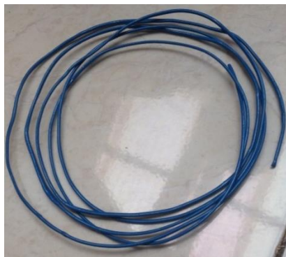
Gambar 3. 11 Hasil ekstrusi pada temperatur 150°C
